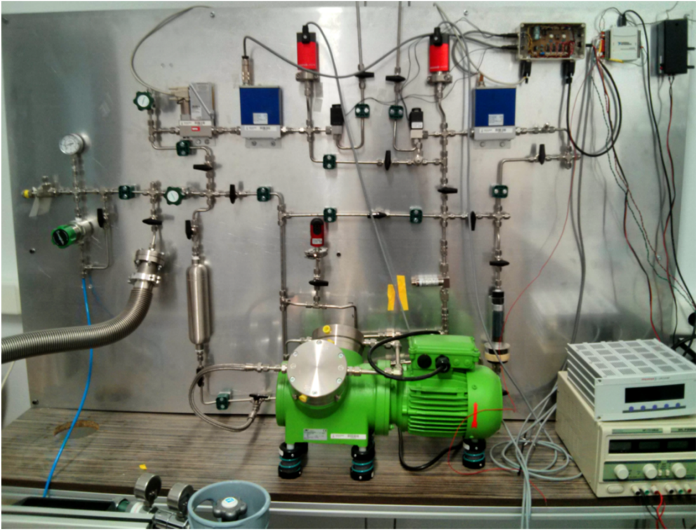
Figure 3.22: Photo of the IAXO-D0 gas system. (TESIS ELISA). TODO: Actualizar con foto de IAXOLAB.
